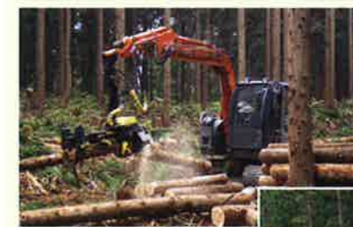
ハーベスタ 立木を伐採・造材する機械
