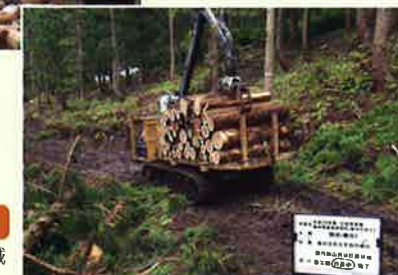
フォワーダ 丸太を搬出する機械
