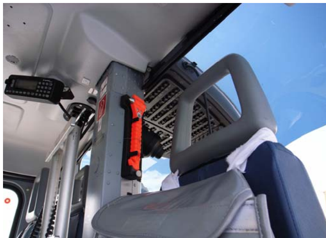
写真9：機内に装備されたガラス破碎器具
